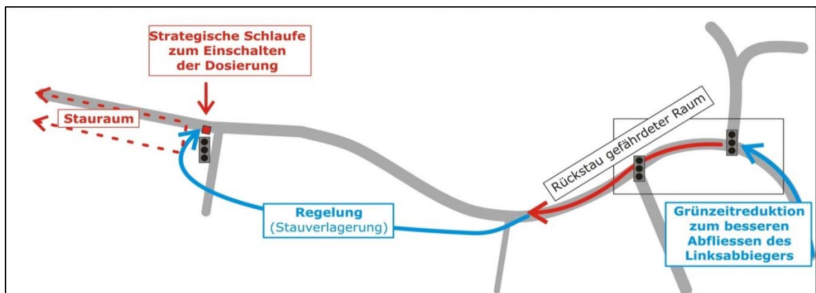
Abbildung 14: Funktionsaufbau Dosier-LSA
